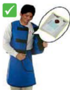
TLD below apron
