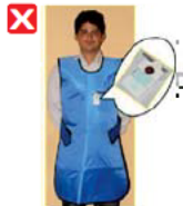
TLD above apron
